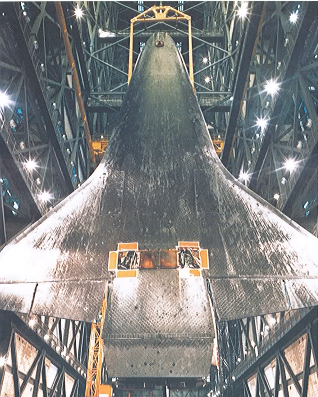
Die mit Hitzeschutzkacheln belegte Unterseite des Space Shuttle bei der Missionsvorbereitung.
